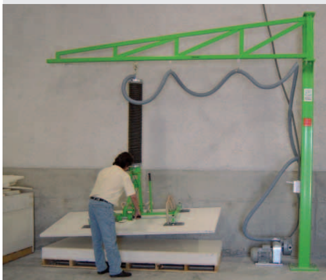
Potence triangulée avec coulissant.
