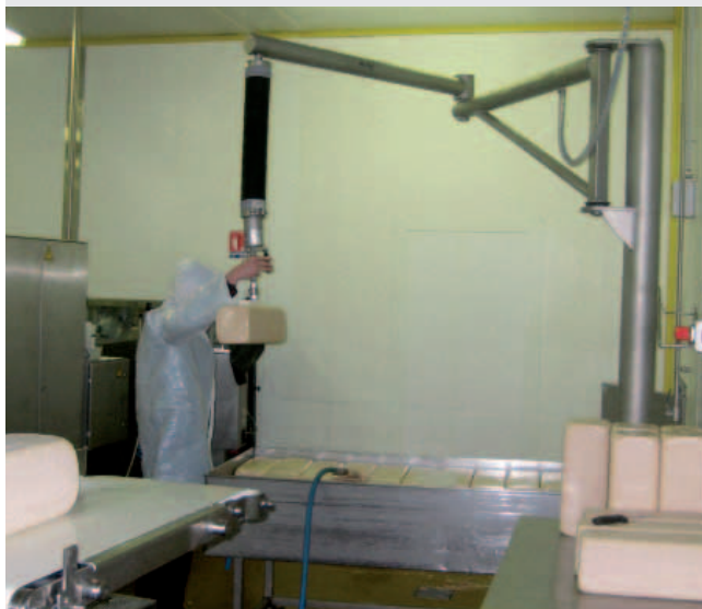
Potence satellite sur fût en inox.
