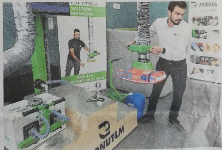
Un des outils de préhension de Manut-LM permet de lever des sacs de 25 kg.
